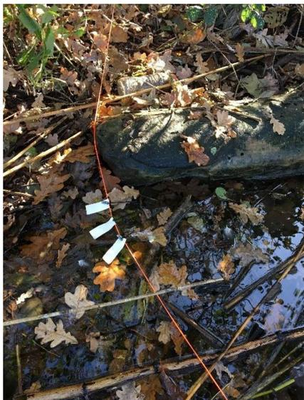
*Figura 3: Le bande di cotone attaccate a una corda con delle fascette per l'installazione sulle rive in zona sommersa, di transizione, ed asciutta (dal basso all'alto nella foto).*
