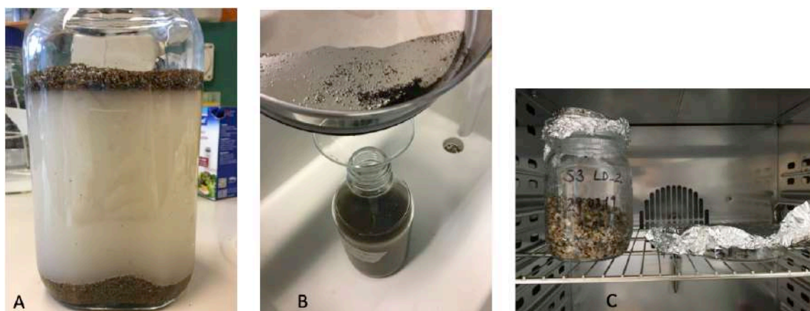
Appendice 19: A) Campione dopo l'agitazione con la soluzione salina. B) Filtrazione e riciclo della soluzione salina. C) Campioni nell'incubatore a 46°C.
