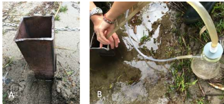
Figura 3: A) Campionatore metallico (10×10 cm). B) Estrazione del campione in acqua con una carota metallica e una pompa per rimuovere l'acqua in esubero.
