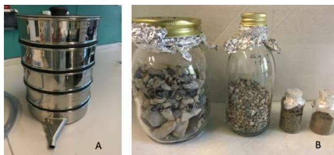
Figura 5: A) Immagine della colonna di setacci usata per la fase di frazionamento. B) Esempio di un campione separato nelle diverse frazioni di grandezza, da sinistra a destra: > 5 mm, 5-1 mm, 1-0.3 mm, 0.3-0.063 mm.
