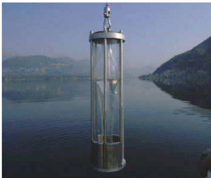
Figura 4: Immagine del campionatore integrale utilizzato per prelevare acqua dalla colonna compresa tra 0 e 20 m di profondità.
