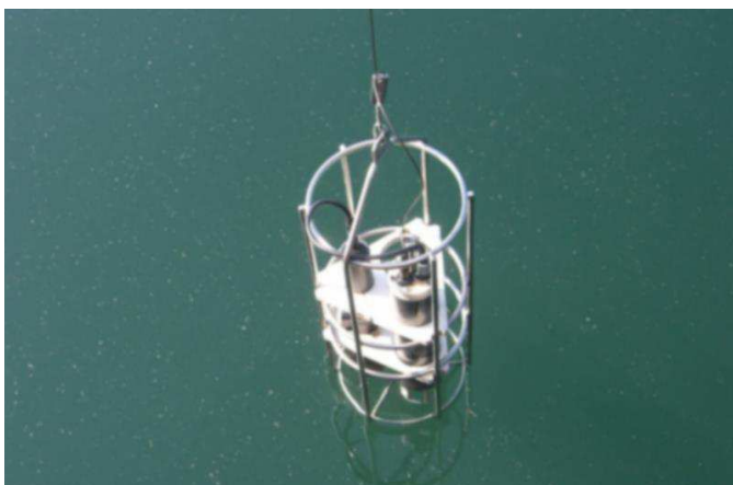
Figura 5: Immagine della sonda multiparametrica impiegata per rivelare in continuo lungo la colonna d'acqua diversi parametri chimico-fisici.
